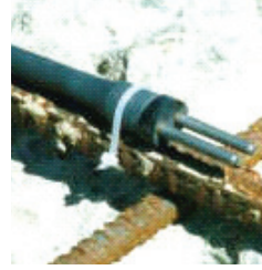
الشكل(9): أجهزة استشعار الاستقطاب الخطي النموذجية المدمجة مثبتة في الخرسانة
